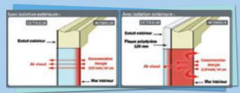
Face à la dégradation des façades, **Oise Habitat** entreprend de **renforcer la qualité de l'enveloppe en isolant la façade** par la pose de plaques de polystyrène de 120 mm. Ce revêtement protègera les murs des variations climatiques. La partie intérieure des murs accumulant la chaleur la restituera dans les logements et les parties communes favorisant une réduction des besoins énergétiques.
